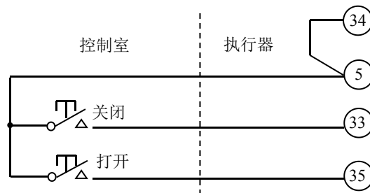
图 4-2 保持式打开/关闭控制，行程可逆，但不能停在中途位置
