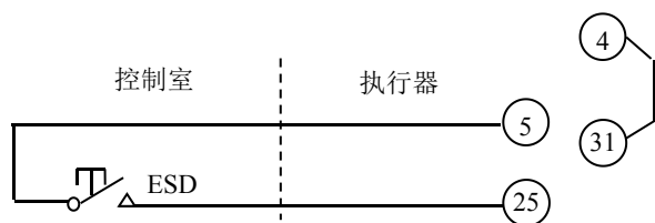
图 4-11 ESD 控制，内部供电。
